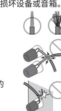
如果开启本机时在前面板显示屏上出现“Check SP Wires”, 则关闭本机, 然后检查音箱缆线是否短路。
