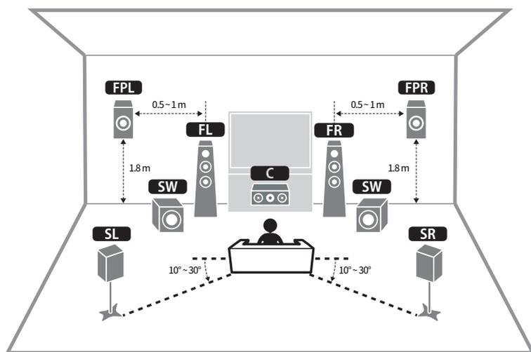
■ 适用于前置现场感音箱处于顶置位置的布置方式
