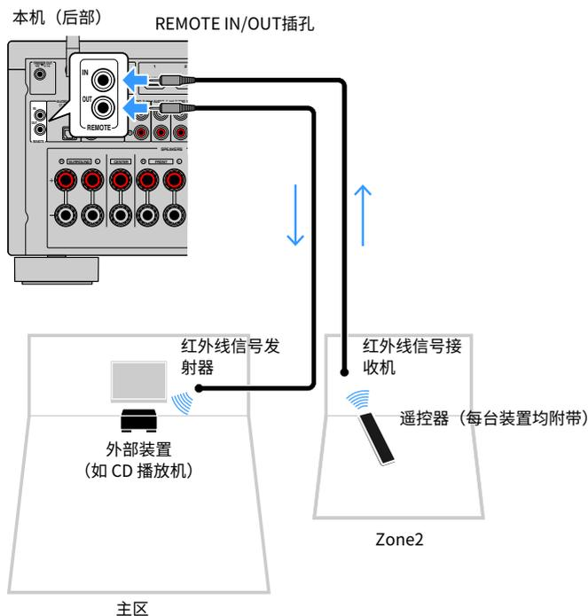
如果您使用的是支持远程连接的 Yamaha 产品（如本机），则不需要红外线信号发射器。通过将 REMOTE IN/OUT 插孔与单声道迷你插孔缆线和红外线信号接收机连接，可以传输遥控器信号。
