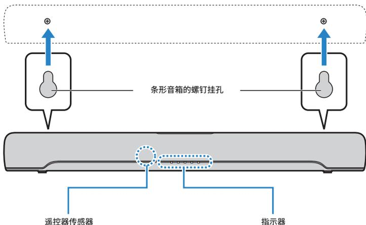
完成所有安装和连接之后，在关闭电源的情况下，按住条形音箱遥控器上的 BASS EXT 至少五秒钟，以优化壁挂式安装的频率特性设置。指示灯如下显示设置状态，且条形音箱已打开。
